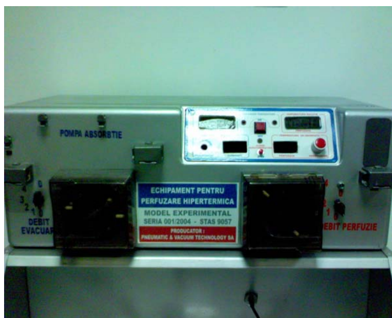
Figura 1 - Aparatul ANTIMETA folosit în terapia intraperitoneală
